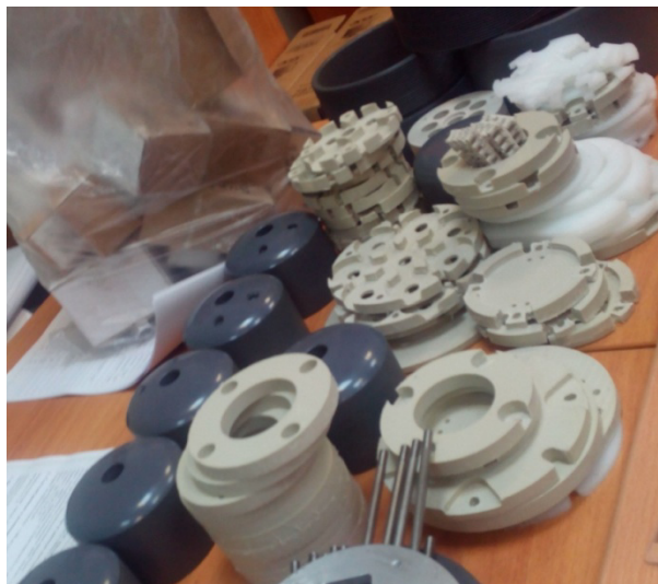
Рис. 3. Качество поверхности деталей после оптимизации режимов резания
